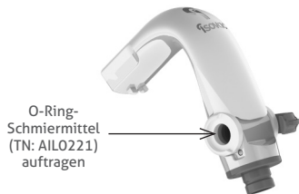
Abbildung 13. Zu schmierender Haltering
