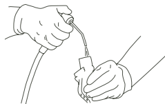
Kuva 6. Suukappaleen holkin suihkuttaminen
