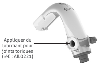
Figure 13. Bague de retenue à lubrifier
