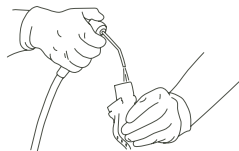
Figura 6. Spruzzare acqua nel manicotto del boccaglio
