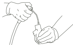
Figure 6. Pulvérisation du manchon de l'écarteur dentaire
