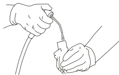
Kuva 6. Suukappaleen holkin suihkuttaminen
