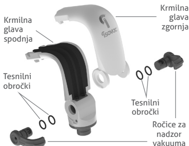
Slika 11: Sestavni deli adapterja za izolacijo zob Isovac
