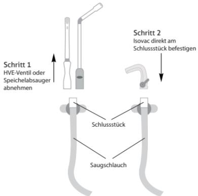
Abbildung 1. Installation ohne Anschlussstück
