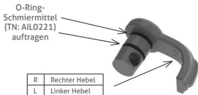
Abbildung 10. Zu schmierende Vakuum-Steuerhebel
