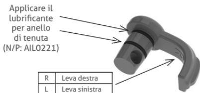
Figura 10. Leva di aspirazione da lubrificare
