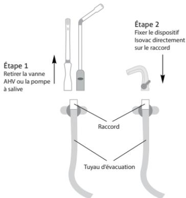
Figure 1. Installation sans adaptateur
