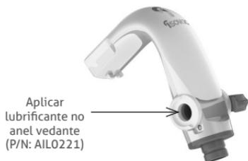
Figura 11. Anel de retenção para lubrificar
