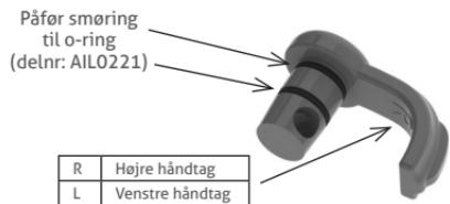
Figur 10. Vakuumhåndtag, der skal smøres
