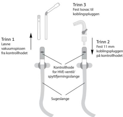
Figur 3. Feste direkte på HVE-ventilens/
