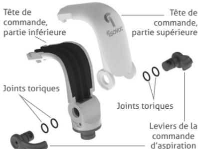
Figure 9. Composants de l'adaptateur pour isolation dentaire Isovac
