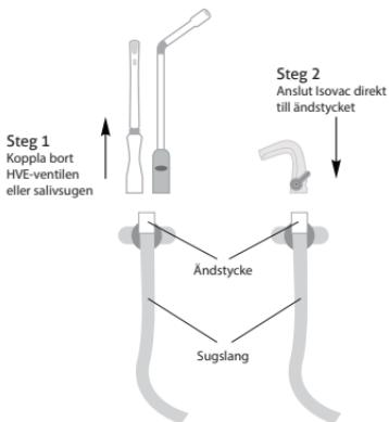
Figur 1. Montering utan en koppling
