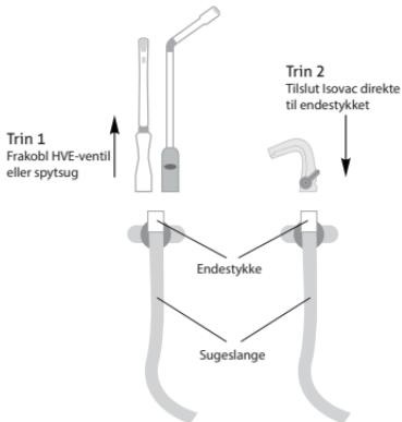
Figur 1. Tilslutning uden en konnektor
