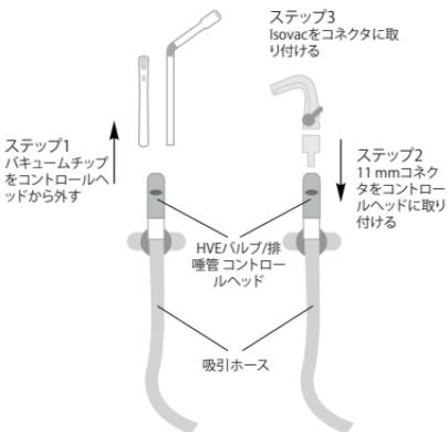
図3 HVE/バルブ/排唾管コントロールヘッド
