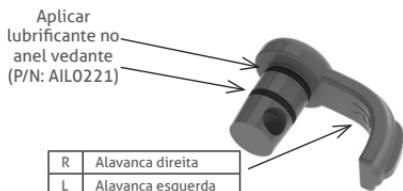
Figura 10. Alavancas de vácuo para lubrificar
