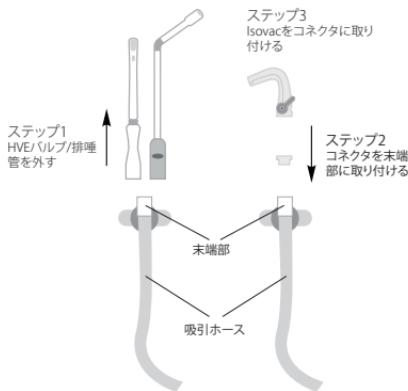
図2 コネクタを使用する取り付け
