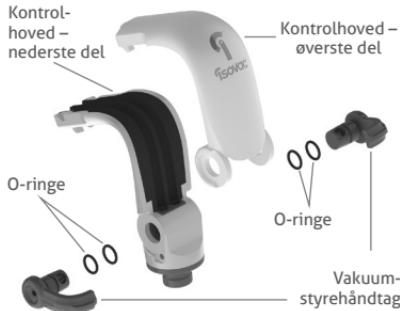
Figur 9. Isovac-adapterkomponenter til tandisolation
