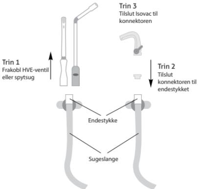
Figur 2. Tilslutning med en konnektor
