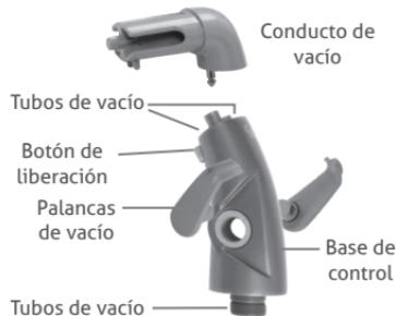
Figura 7. Cabezal de control
