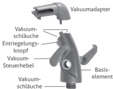
Abbildung 7. Steuerkopf
